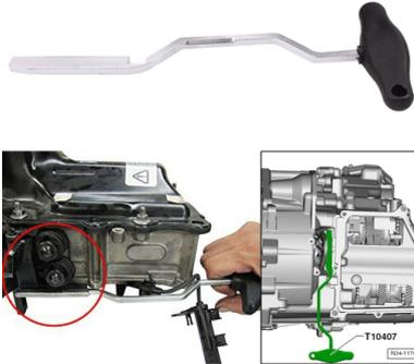
Spezialwerkzeug für die De-/Montage der Mechatronik bei Fahrzeugen mit 7-Gang DSG Getriebe 0AM von VAG. Das Werkzeug dient zur Entriegelung der beiden Einrückhebel.
