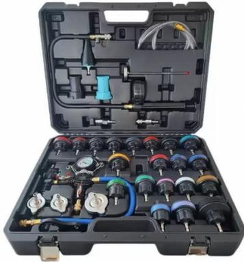
Handpumpe erzeugt über fahrzeugspezifische Adapter auf dem Kühler bzw. Ausgleichsbehälter einen Überdruck im System und lässt per Druckanzeige Dichtigkeit prüfen. Aufgrund des Überdrucks im System können so bei Druckverlust Leckagen per Sichtprüfung gefunden werden.
